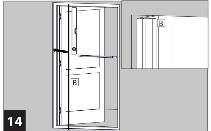
**14** Halten Sie das Wandprofil **B**, in einem Abstand von 2 cm zum Türrahmen, an der gewünschten Seite der Mauerlaibung an und zeichnen die Bohr-/Schraublöcher an.
