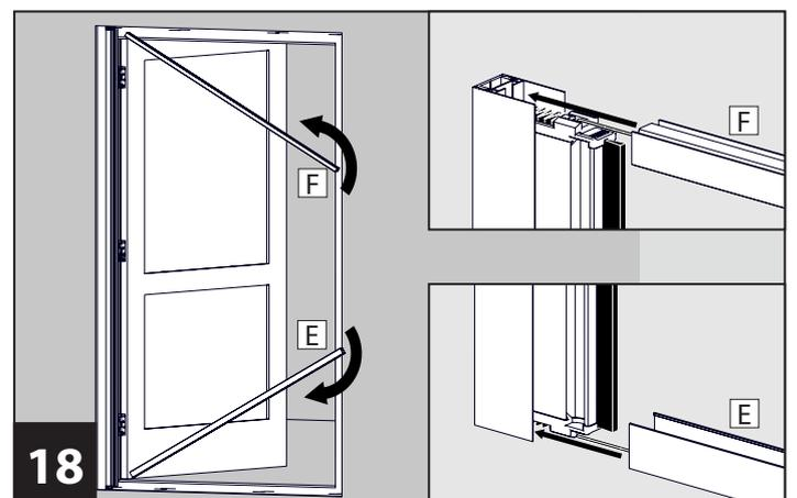
**18** Setzen Sie das Führungsprofil oben **F** und das Führungsprofil unten **E** ein.
