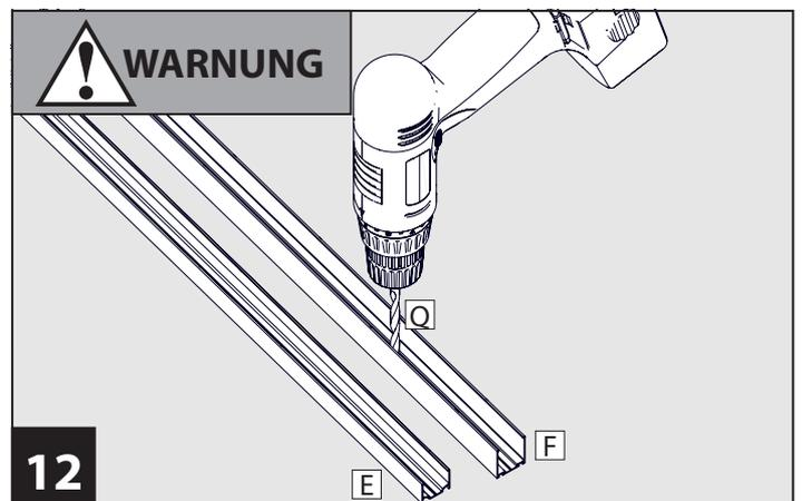
Bohren Sie die Führungsprofile oben **E** und unten **E** jeweils an drei auf die Länge gleichmäßig verteilten Position vor. Verwenden Sie dazu den  $\varnothing$  4 mm Bohrer **Q**.
