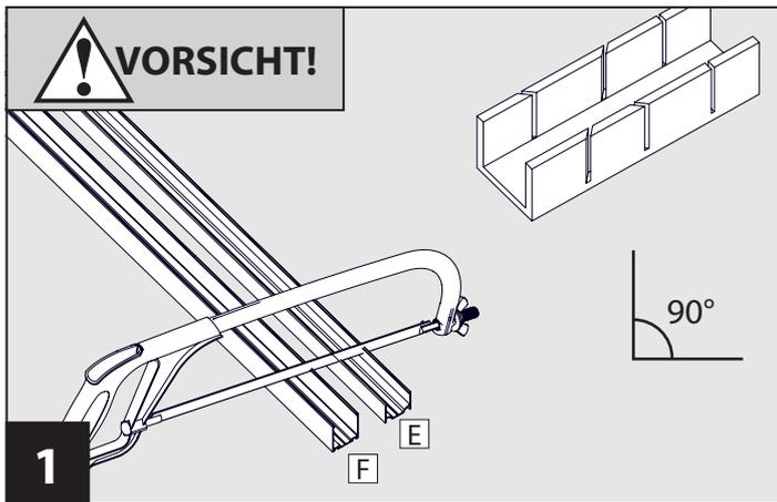
1 Kürzen Sie das Führungsprofil oben **F** und das Führungsprofil unten **E** auf gemessene Breite - 1,8 cm.
