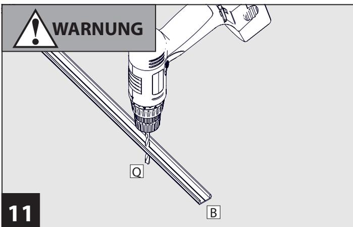
Bohren Sie das Wandprofil **B** an drei auf die Länge gleichmäßig verteilten Position vor. Verwenden Sie dazu den  $\varnothing$  4 mm Bohrer **Q**.
