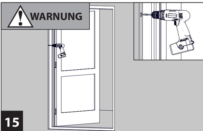
**15** Bohren Sie die markierten Positionen mit einem  $\varnothing 6$  mm Bohrer vor (je nach Untergrund ist ein geeigneter Bohrertyp zu verwenden).
