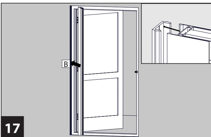
**17** Klipsen Sie die vormontierte Plisseekassette auf das angebrachte Wandprofil **B**.
