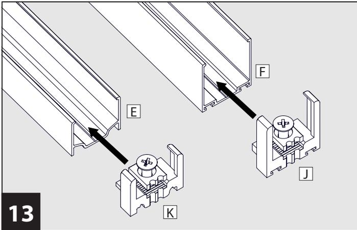
**13** Setzen Sie den Schnurspanner oben **J** auf das Führungsprofil oben **F** auf.
