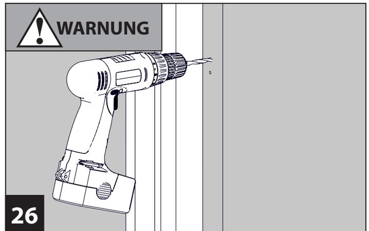
**26** Bohren Sie die markierten Schraublöcher mit einem  $\varnothing 6$  mm Bohrer vor (je nach Untergrund den passenden Bohrertyp verwenden).
