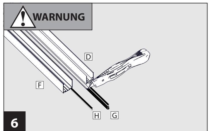
6 Ziehen Sie die Bürstendichtung Griffprofil **G** in das Griffprofil **D** ein.
