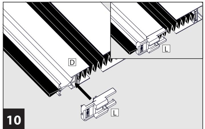
Setzen Sie die Abdeckkappen **L** auf beiden Seiten des Griffprofils **D** auf.
