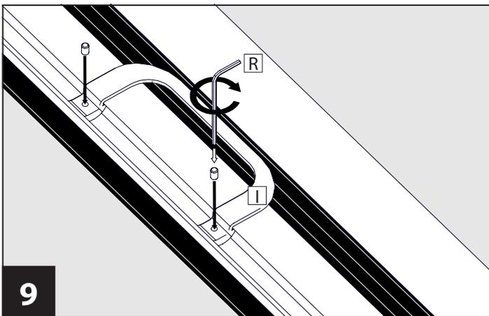
Schieben Sie den Handgriff **I** auf eine für Sie angenehm zu bedienende Höhe. Wir empfehlen ca. 105 cm ab Boden. Fixieren Sie den Handgriff **I** mittels Innensechskantschlüssel **R** durch Eindrehen der Innensechskantschrauben (bereits im Handgriff **I** vormontiert).
