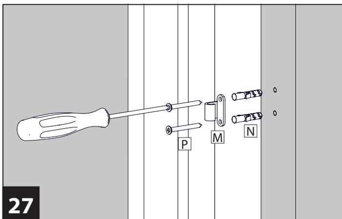
**27** Setzen Sie die Dübel **N** ein. Befestigen Sie den Schließhaken **M** mit den Senkkopfschrauben **P**.
