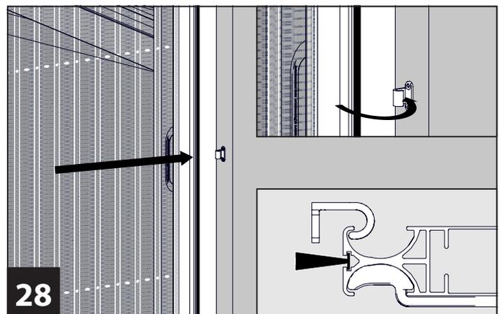
**28** Schließen Sie die Insektenschutz Alu-Plisseetür und hängen das Griffprofil am Schließhaken ein.
