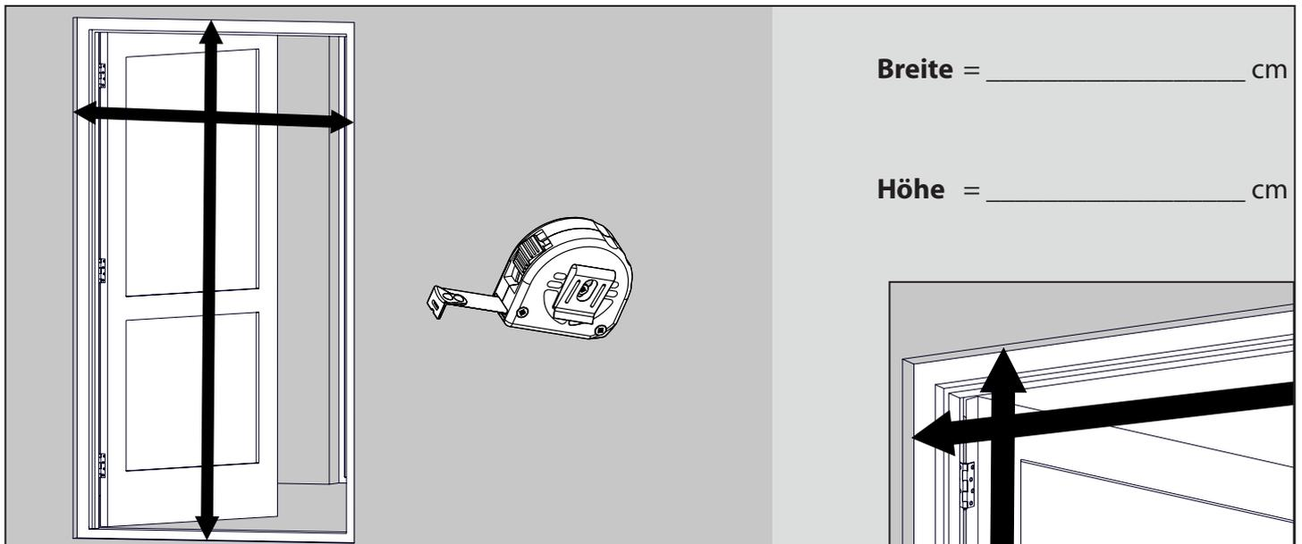
Messen Sie die Mauerlaibung von Innenkante zu Innenkante (lichtes Maß) und notieren Sie sich das Ergebnis.
