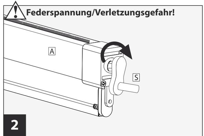
**Achtung! Verletzungsgefahr, da die Feder unter Spannung steht.** Handkurbel im Uhrzeigersinn drehen, um das Gewinde der Feder zu öffnen.
