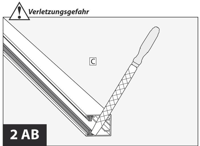
Schnittkante mit Hilfe einer Metallfeile entgraten.
