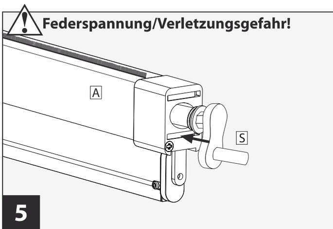
Nach Spann- bzw. Entspannvorgang das Gewinde zurück in die Kassette schieben.
