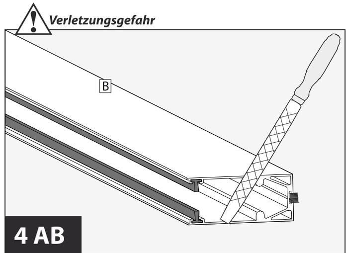
Schnittkante mit Hilfe einer Metallfeile entgraten.
