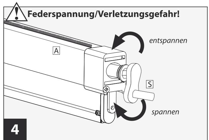
Feder spannen: Drehen im Uhrzeigersinn.
