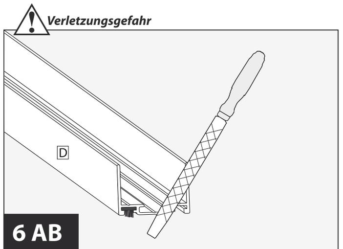
Schnittkante mit Hilfe einer Metallfeile entgraten.
