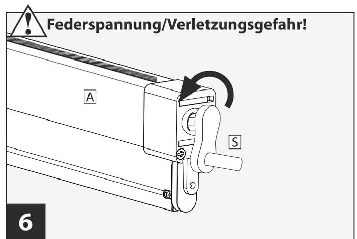
Gewinde durch Drehen gegen den Uhrzeigersinn verschließen.
