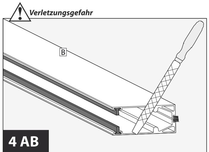
Schnittkante mit Hilfe einer Metallfeile entgraten.
