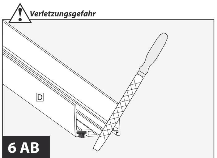
Schnittkante mit Hilfe einer Metallfeile entgraten.
