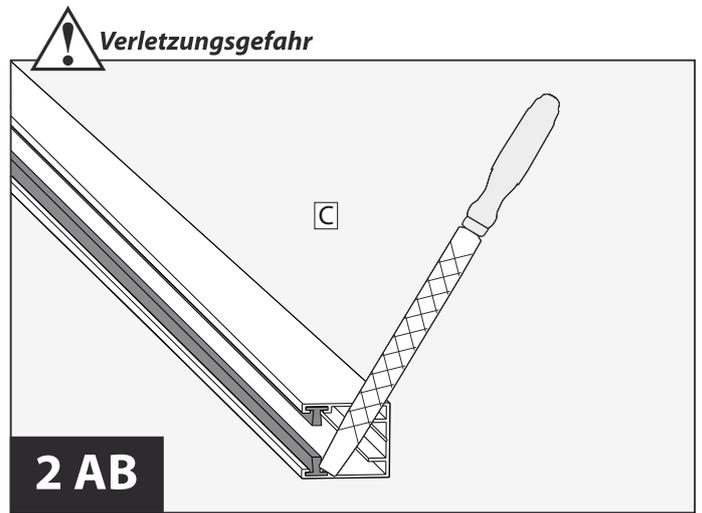
Schnittkante mit Hilfe einer Metallfeile entgraten.
